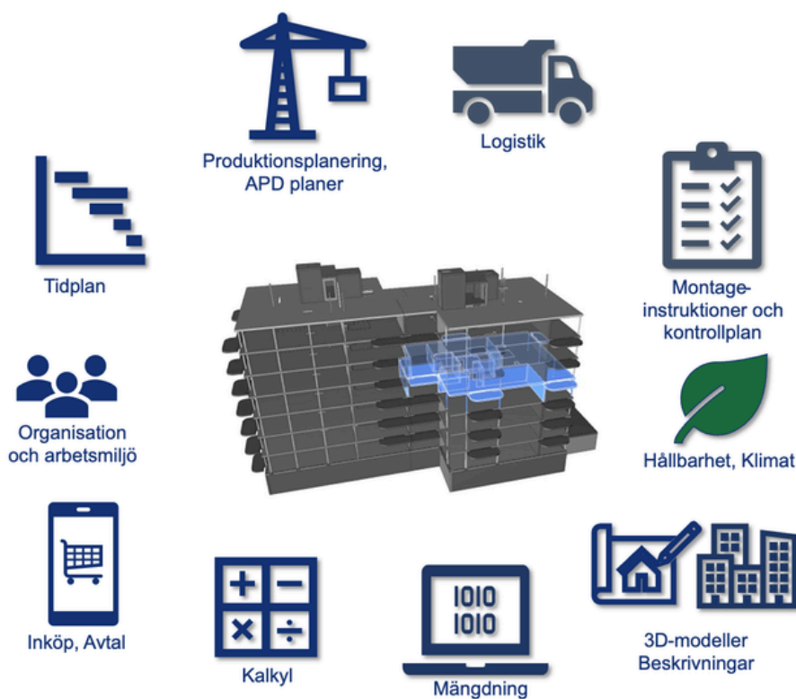
Figur 3. Princip för samläsning, där information från olika system samordnas per produktionskede så att modell, tidplan, kalkyl och övrig projektinformation kan läsas tillsammans i en gemensam struktur (Ljung, E., BIM-baserad virtuell taktplanering).
